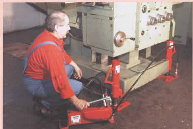
Deux lève-machines en service avec pompe séparée →
