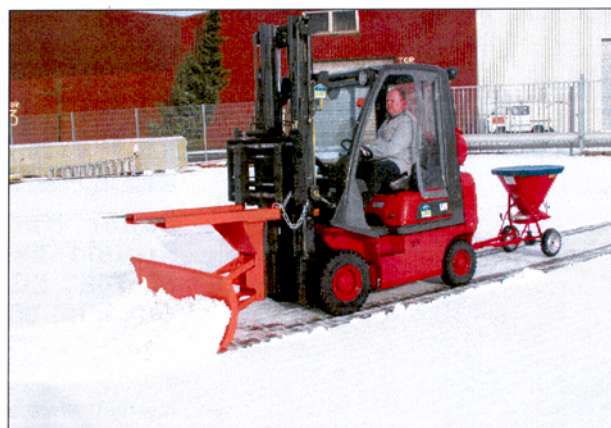
Type STW in combinatie met de BAUER-sneeuwplough type SCH-P
